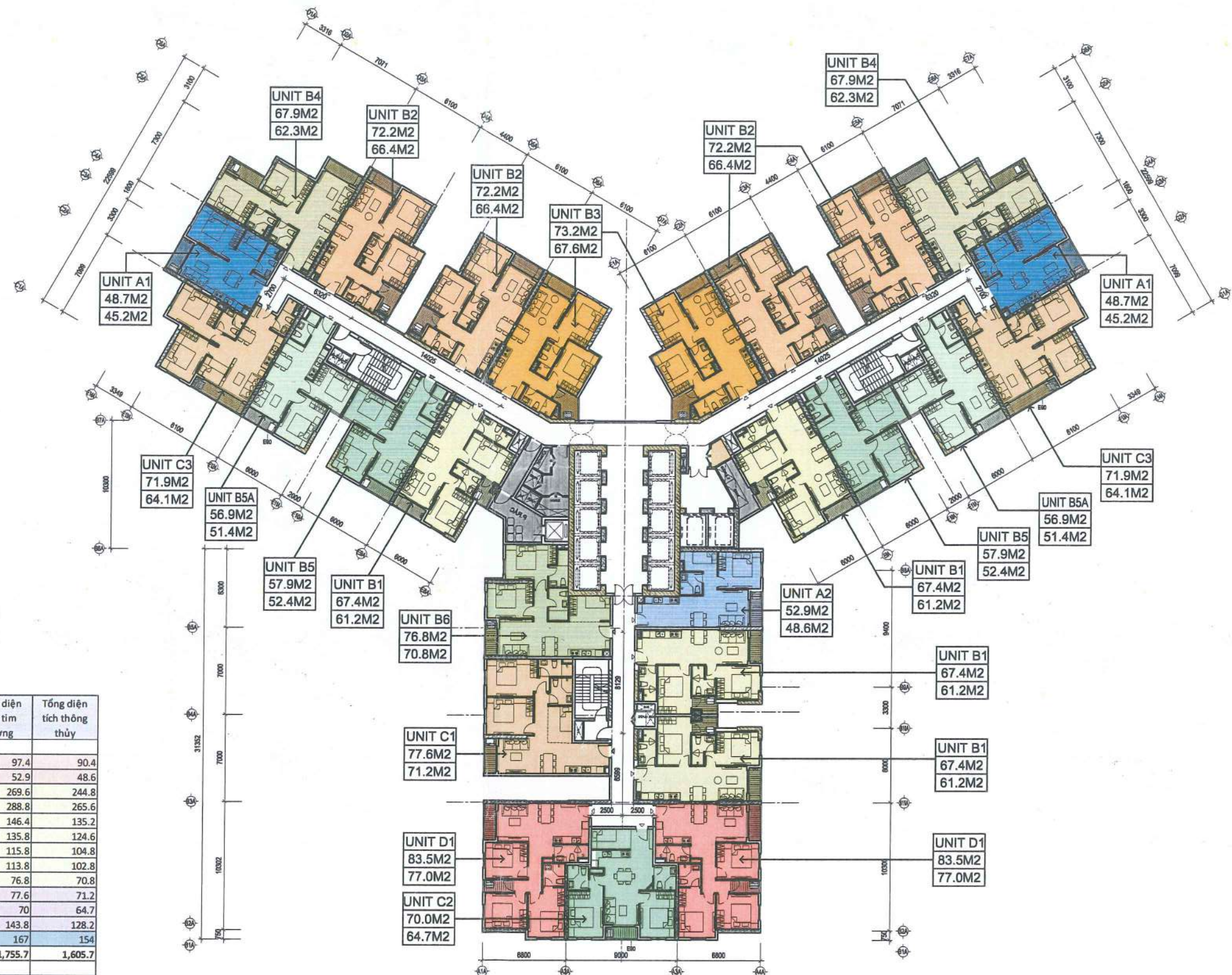
MẶT BẰNG ĐIỂN HÌNH TOWER 1 TỶ LỆ: 1:150
